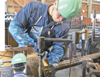
ネジ切り盤 (第1工場)
